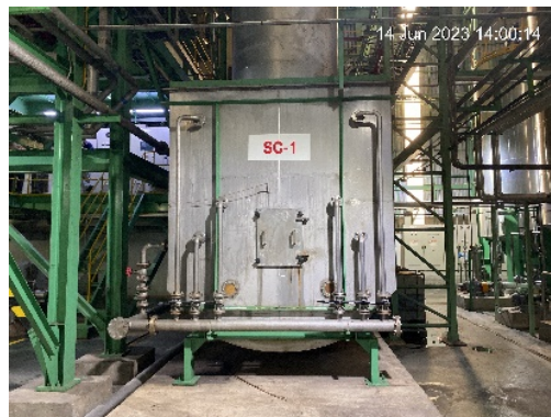
ปล่อง Spray Dryer Burner
